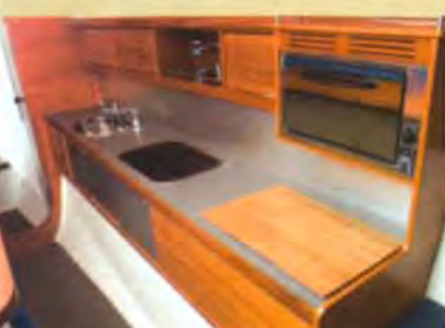
Det langskibs pantry er rummeligt og praktisk fx dækker spækbrættet over en køleboks og gasblussene er nedfældet i bordet.
