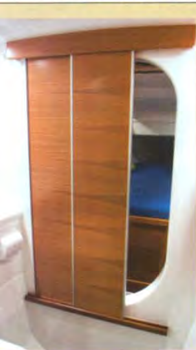
Der er valgt en klassisk og praktisk skydedør mellem toilet og forkahyt. Skydedøren er to-delt og det giver ekstra plads.
